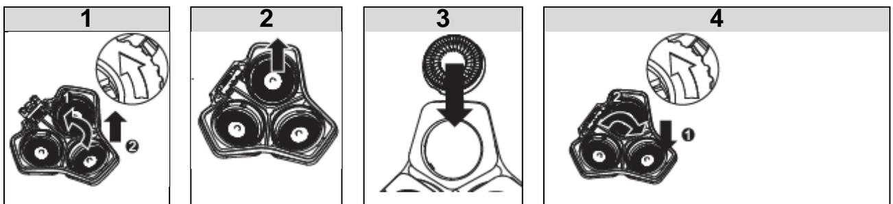
Drehen Sie den Scherkopf gegen den Uhrzeigersinn und heben Sie ihn dann an.
