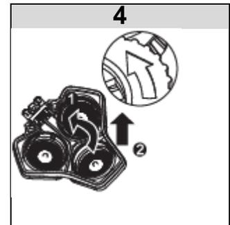
Klappen Sie den Scherkopf zu. Drehen Sie den Scherkopf im Uhrzeigersinn, bis er fest sitzt.
